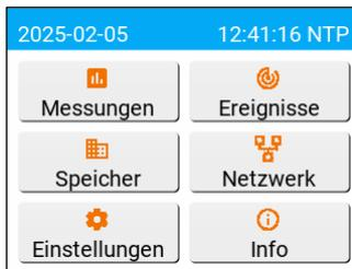
Das Hauptmenü ist in Abb. 7 dargestellt. In der oberen Leiste werden das aktuelle Datum und die aktuelle Uhrzeit des Analysators sowie die Quelle der Uhrzeit (RTC / GPS / NTP / IRIG) angezeigt.
